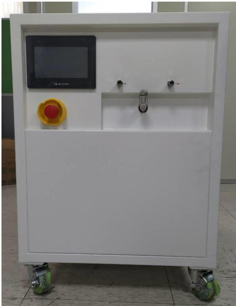
圖 28、初代鹼性水電解產氫原型機實際機組。
