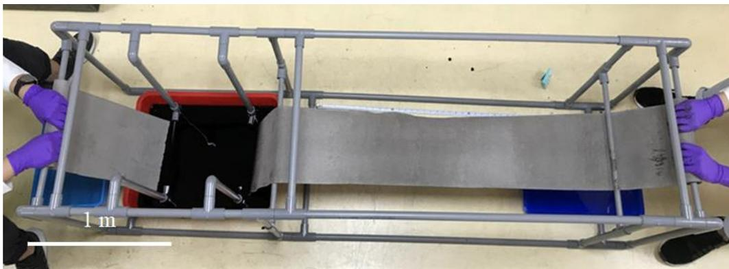
圖 13、捲送製程進行試量產薄膜催化劑。
