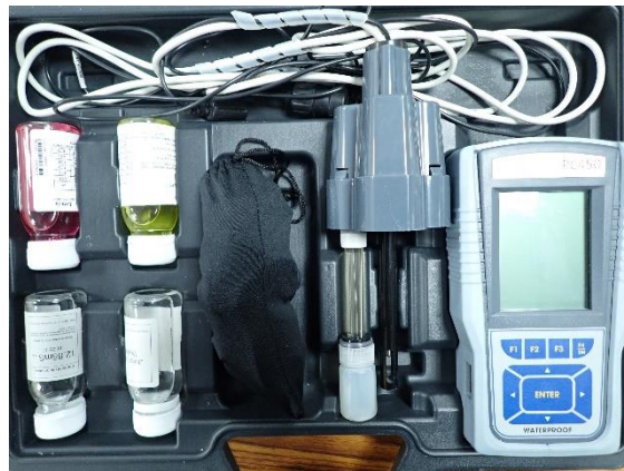
圖 1.防水型手持酸鹼電導度計型號：Eutech PC 450
