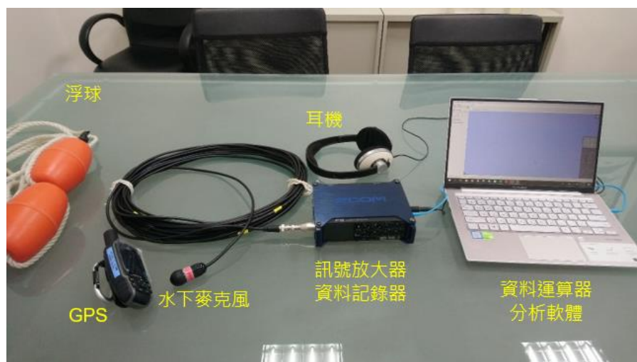
圖 37 拖曳型被動聲學監測系統
