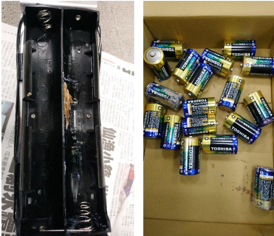
圖 30 電池發生爆炸露出化學液體
