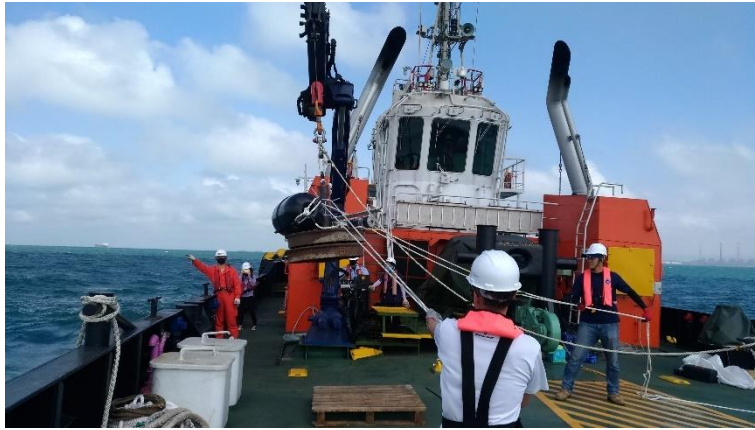
圖 29 配備吊具的工作船舶布放水下聲學監測系統
