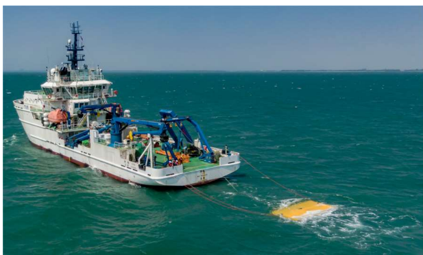
圖 1-12 10 kW 洋流發電渦輪機實海拖曳測試
