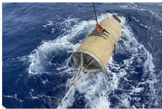
圖 1-13 防水機艙耐壓測試
