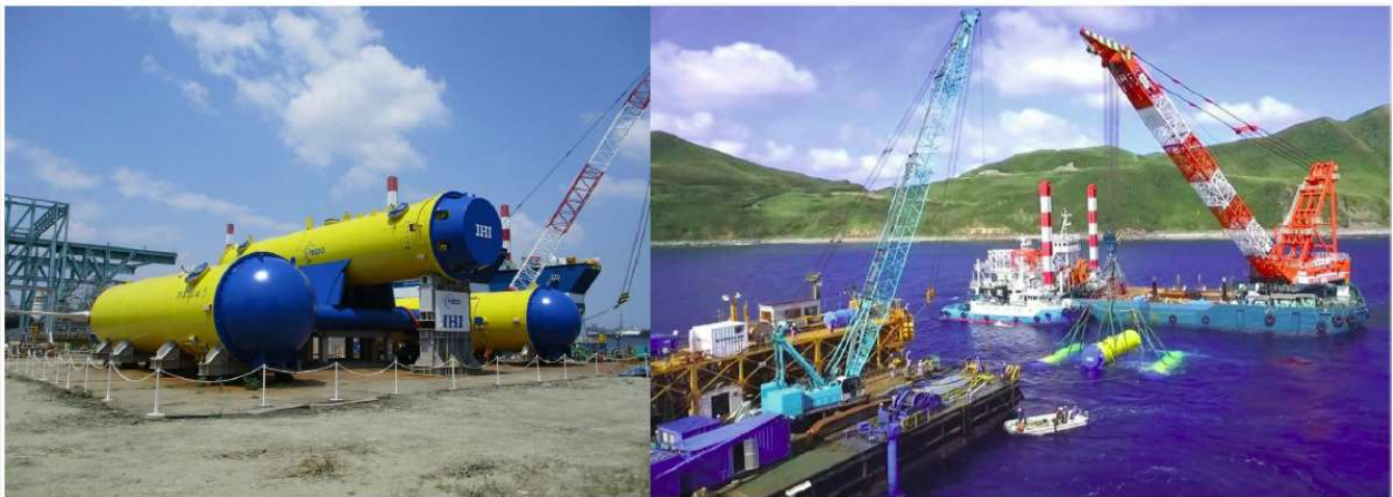
圖 6-1 「かいりゅう」浮游式黑潮發電渦輪機實海測試
