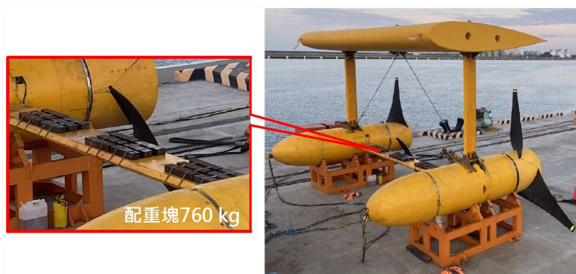
圖6-20 20 kW FKT水平橫桿之配重塊
