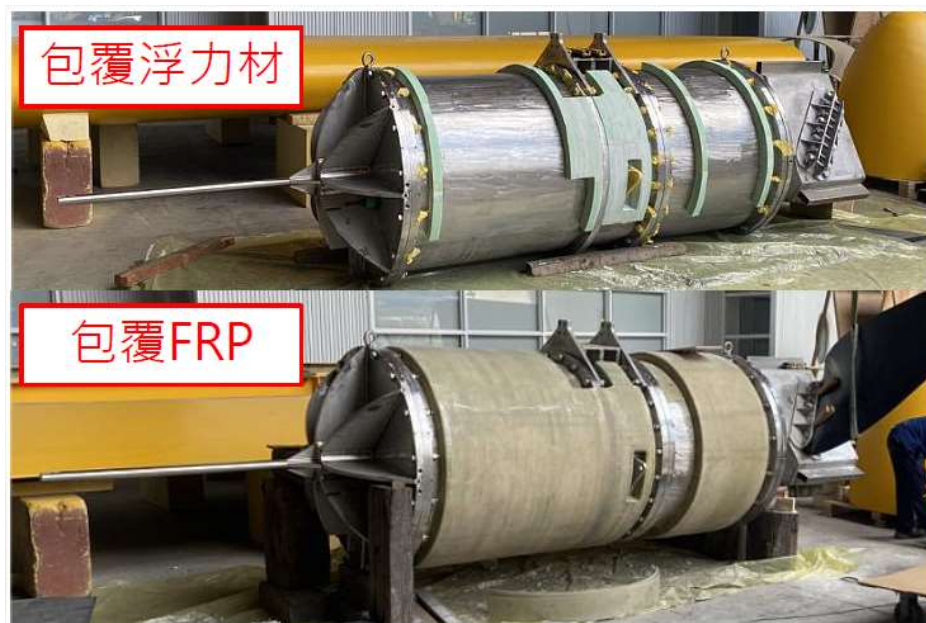
圖2-73 10 kW FKT防水機艙完成組裝之實體
