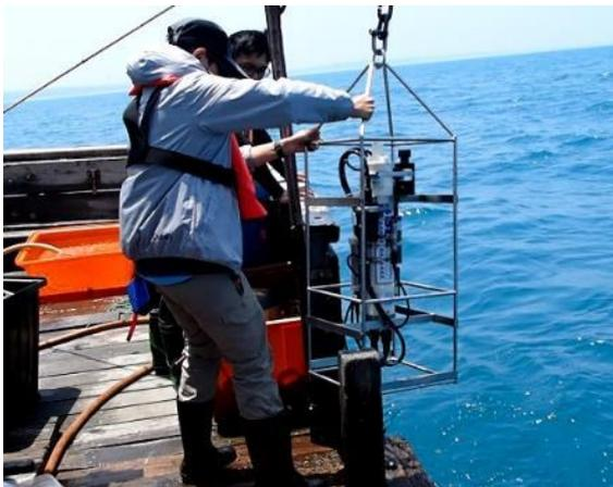
圖 2-4、W14 測站 CTD 量測情形
