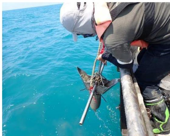
圖 2-24、W14 測站錨錠式採泥器採樣情形
