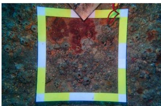
圖 2-59、第一次海域調查 W21 測站風機基樁底層附著性底棲生物
