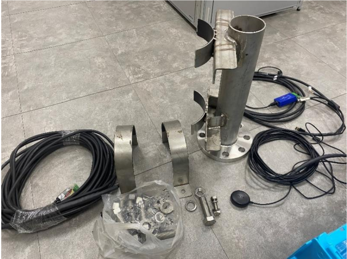
圖 7、海流儀固定於船底支架
